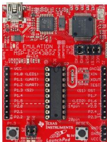
Рис. 4. Внешний вид launchpadMSP430G2553
